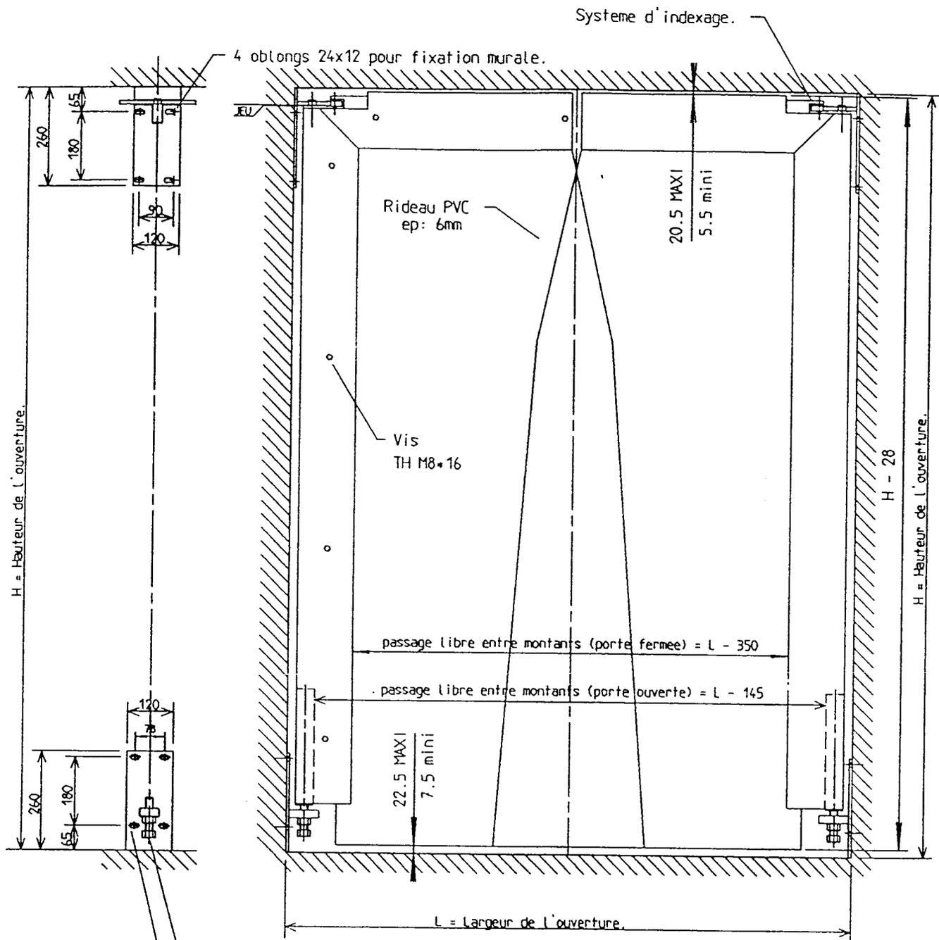
vis de réglage en hauteur avec contre écrou pour blocage.
