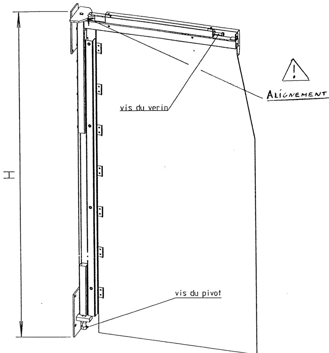
b - Regler la position en hauteur du vantail à l'aide de la vis de réglage du pivot inférieur et bloquer avec le contre écrou.
